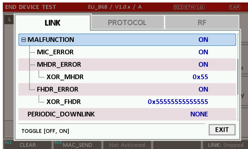
Fig 3.31 Malfunction configuration parameters
